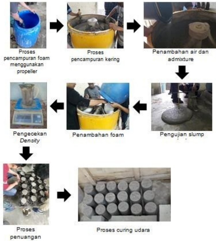
Gambar 2. Proses Pengecoran Beton Ringan
